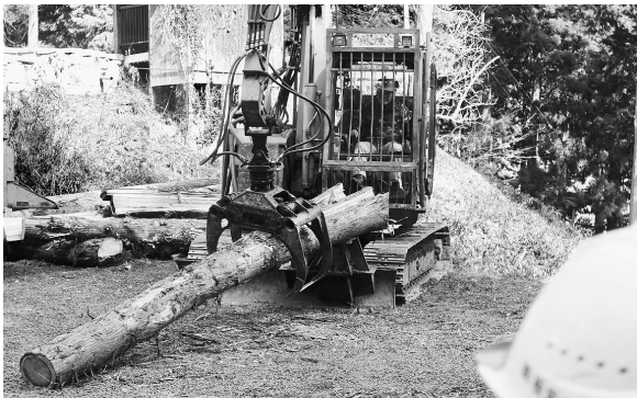
乾燥を促すため回転するドリルの先端に丸太を押し付けて割る
