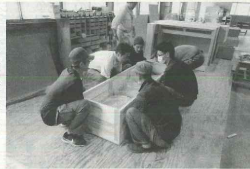
棺のなかに砂袋を入れて耐荷重を測定
